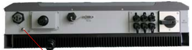
Terminale con messa a terra esterno (PROTETTIVO)
